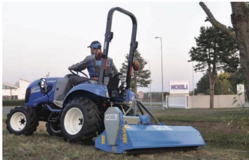
Molinella (BO) 15 agosto 2021 - I TRITURATOR NOBILI TL e TLP sono attrezzature di tipo semiportato, applicabili ai tre punti del sollevatore idraulico, posteriore o anteriore, di piccole trattrici.
