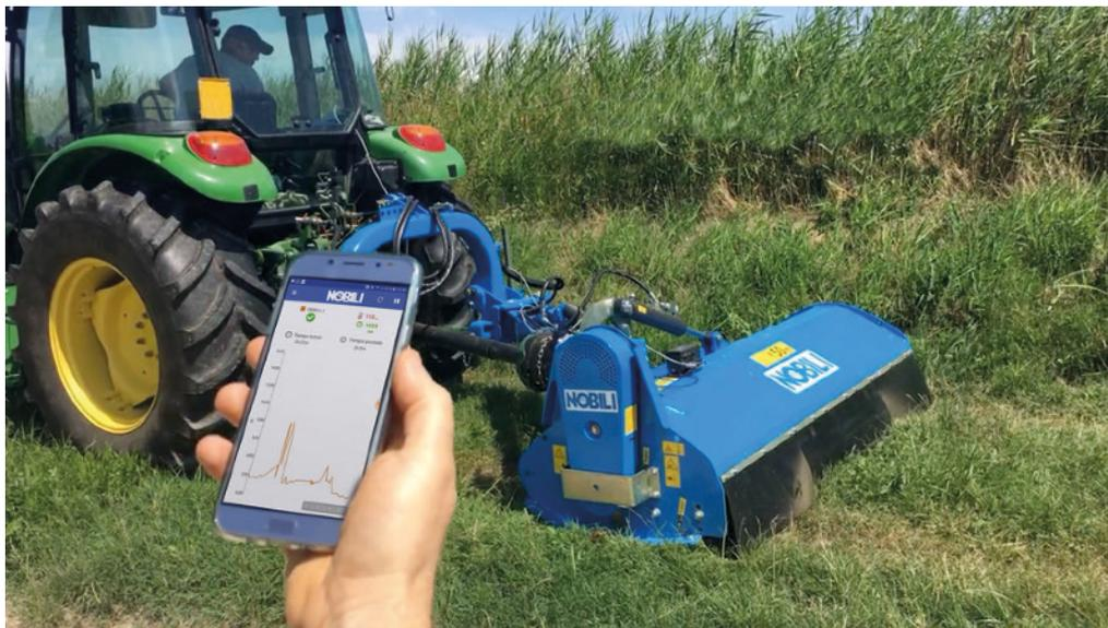
Si tratta di un **sistema di sensori**, interfacciabile a un qualsiasi smartphone/tablet e connesso attraverso connessione Bluetooth, che permette, dopo aver scaricato scaricando l'apposita App dagli store ufficiali – oppure da remoto grazie all'interconnessione resa possibile dal modulo dati e dal web service **NMI connect** – di **monitorare** in tempo reale
