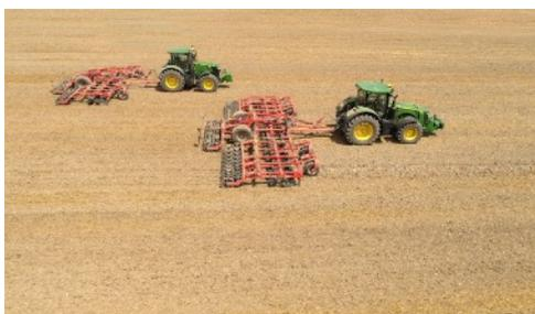
il sistema di livellamento Steady Control. L'asse centrale garantisce stabilità e grande maneggevolezza non solo nelle svolte a fine campo, ma anche per il trasporto su strada in totale sicurezza. I telai OPTIMER XL 6000 e 7500 possono essere dotati di una seminatrice SH e di una testata di distribuzione pneumatica associata alla tramoggia frontale TF 1512, il che significa che è possibile fare la lavorazione delle stoppie e
