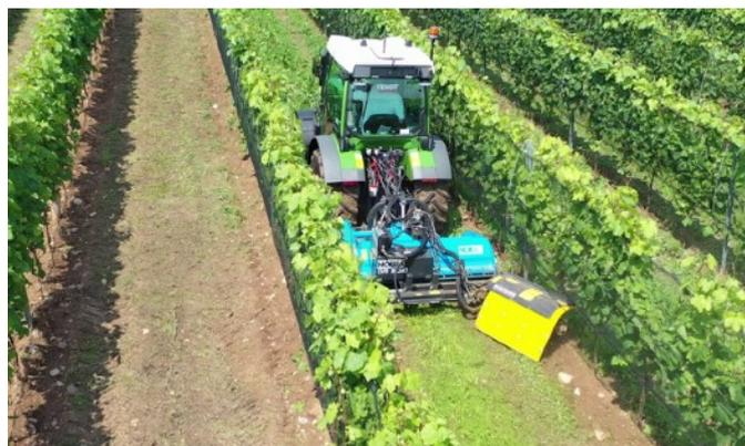
in grado di eliminare meccanicamente le erbe infestanti presenti nel raggio di azione, senza danneggiare i fusti delle piante.
