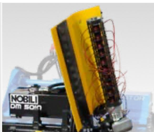
**Rotore con fili in nylon facilmente sostituibili singolarmente (set di fili preinstallato)**
